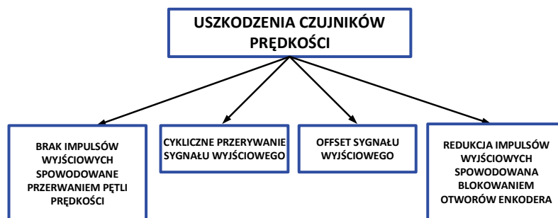
Rys. 5. Rodzaje uszkodzeń czujników prędkości
